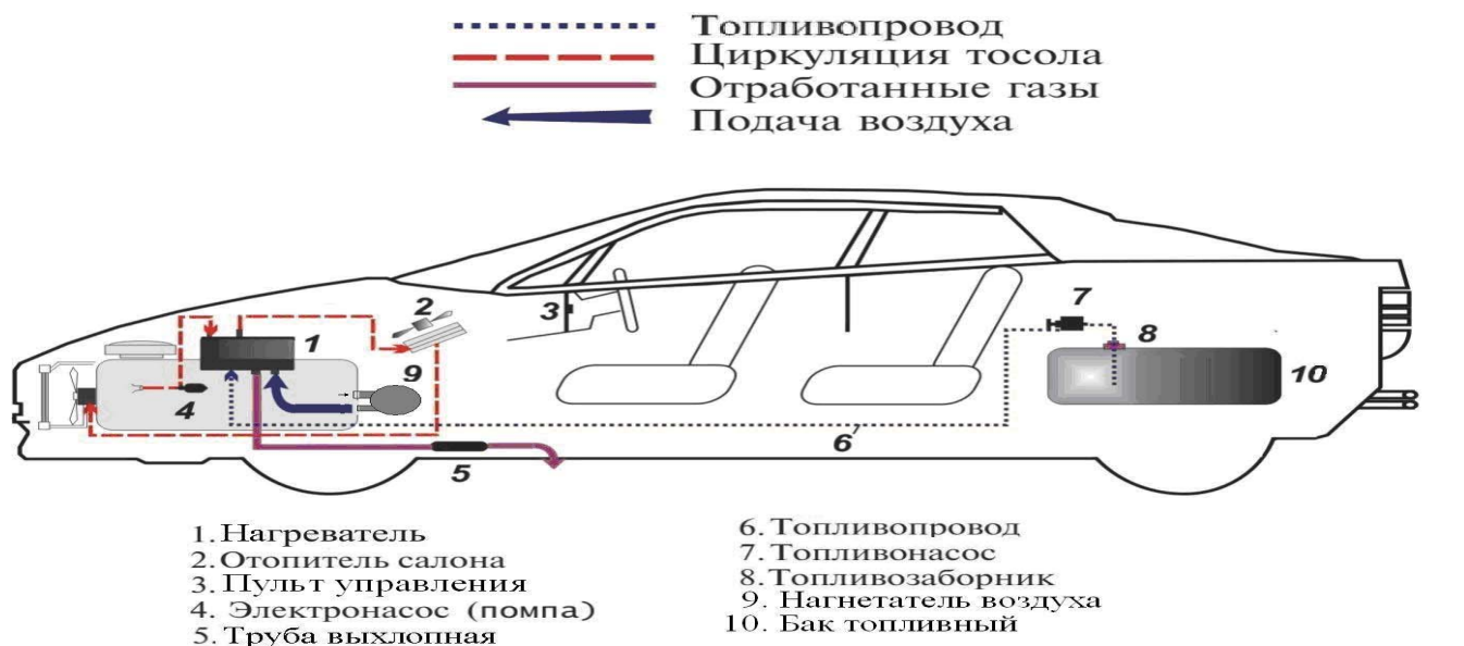
Рис. 7.1- Схем установки подогревателя на автомобиль
