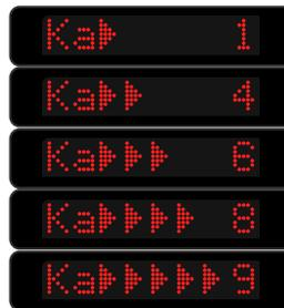
Имитация обнаружения сигнала в диапазоне Ka с демонстрацией графического и числового индикатора мощности обнаруженного сигнала. Прозвучит голосовое оповещение: «Обнаружен сигнал в диапазоне ка-а» и индивидуальный, для диапазона Ka, мультитональный сигнал тревоги. Интенсивность мультитональной тревоги пропорциональна мощности принимаемого сигнала.
