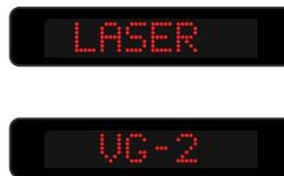
Имитация обнаружения сигнала лазера и системы VG-2. Прозвучат соответствующие голосовые оповещения: «Обнаружен сигнал в лазерном диапазоне» и «Обнаружен сигнал вз-гз два». Голосовое оповещение продолжит индивидуальный для этих диапазонов мультитональный сигнал.
