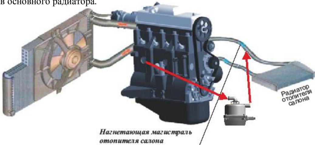
3. В двигателях с **верхним (нижним) расположением термостата** возможна схема: забор охлаждающей жидкости в подогреватель из сливного отверстия блока цилиндров, подача – в верхний рукав отопителя салона (идущий от головки цилиндров в радиатор отопителя салона).
