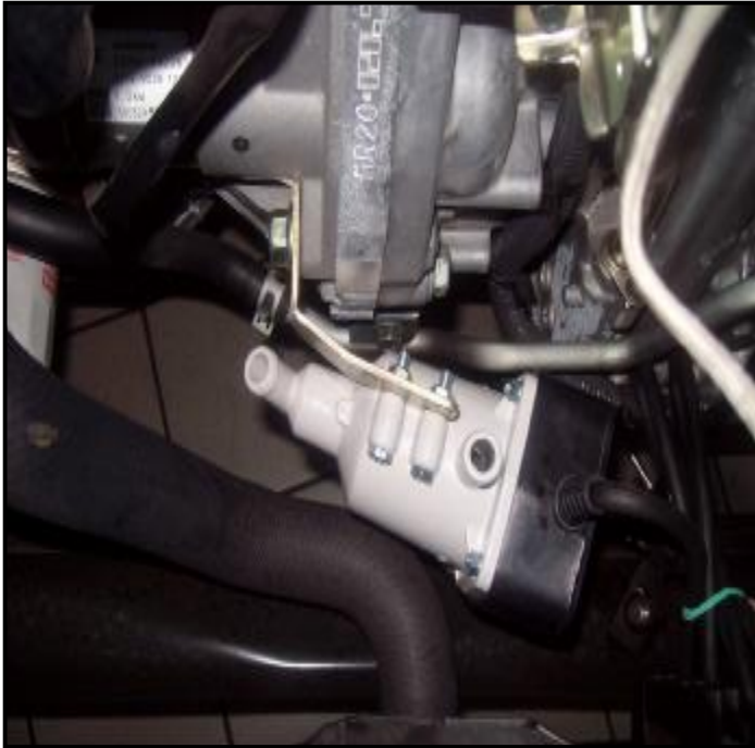
Рисунок 1. Положение подогревателя и его крепление на двигателе.
