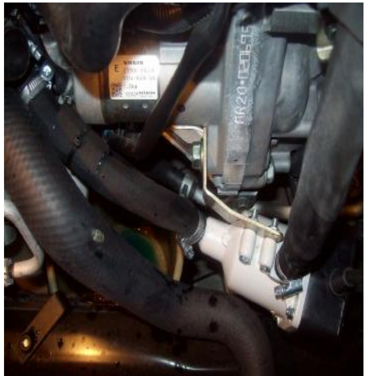
Рисунок 4. Положение входного рукава и фиксация защитного рукава.
