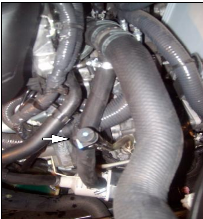
Рисунок 3. Врезка тройника 35x16 и фиксация выходного рукава к щупу АКП
