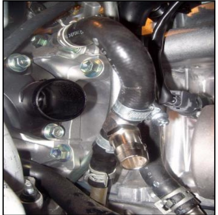
Рисунок 2. Врезка тройника 14x16 (нижний патрубок снят).
