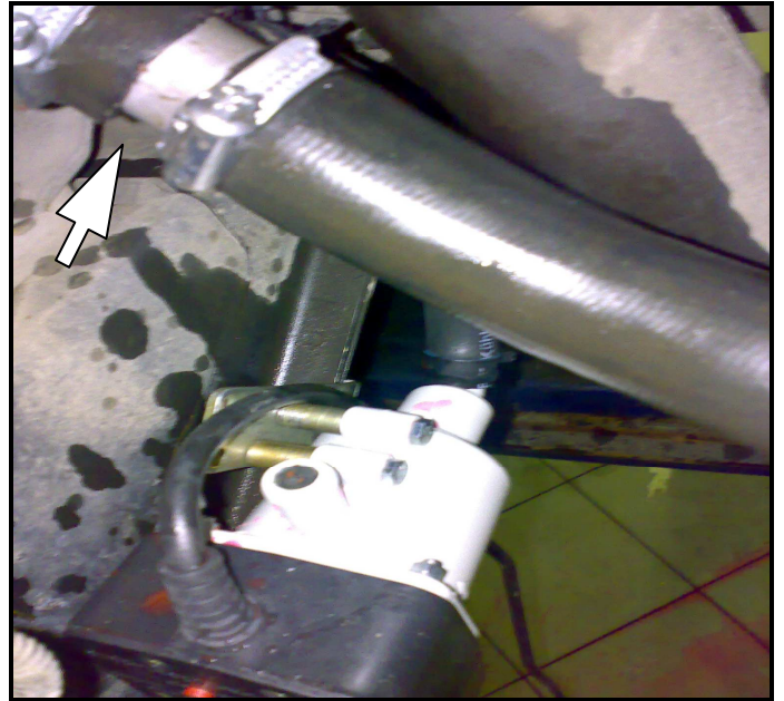
Рис.2. Врезка тройника 28x28x16 входного рукава, положение подогревателя.
