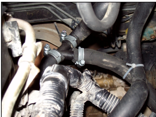
Рис.3. Монтаж тройника Ø16 и входного рукава.
