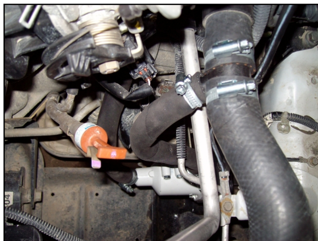
Рис.4. Монтаж тройника Ø33×16, входного и выходного рукава.
