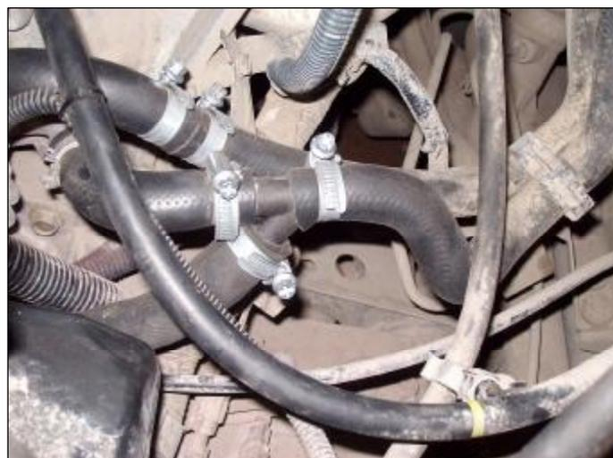
**Рис.2. Схема монтажа тройника и выходного рукава.**
