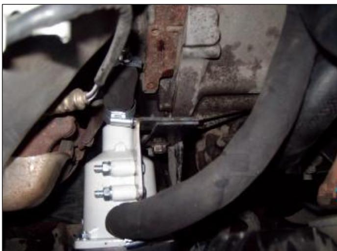
**Рис.1. Схема монтажа кронштейна с электроподогревателем, штуцера, входного и выходного рукавов.**
