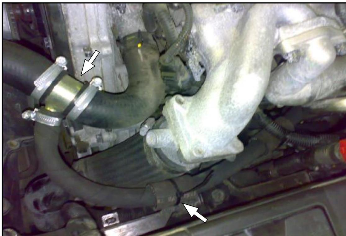
Рис. 3 Положение тройника 35x16 и фиксация рукава
