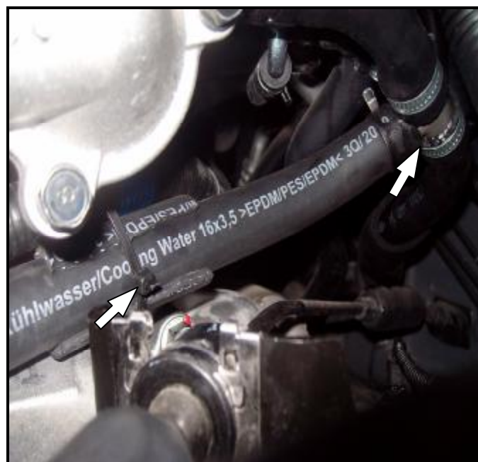
Рис. 3 Монтаж тройника 19x16 входного рукава и фиксация его
