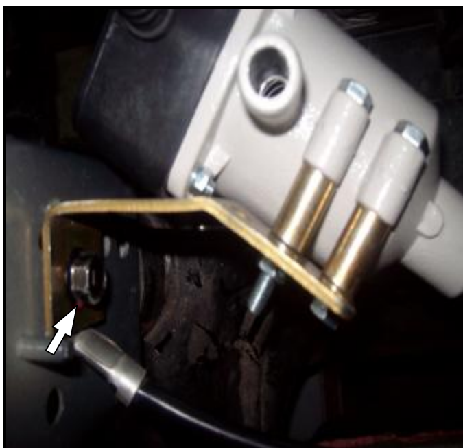
Рис. 1 Положение подогревателя и болт крепления
