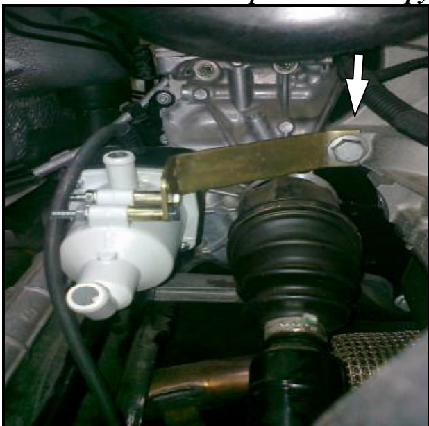
Рис.1 Положение подогревателя и болт крепления кронштейна к двигателю
