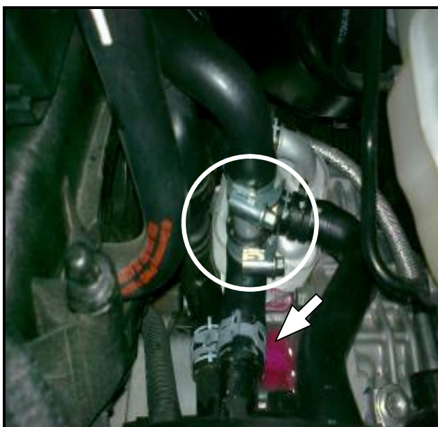
Рис.3 Положение тройника 19x16 и резка подающего патрубка отопителя салона, отвод направлен к задней части двигателя
