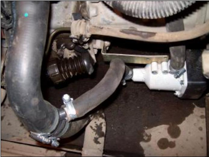
**Рис.1. Схема монтажа кронштейна с электроподогревателем, тройника  $\text{Ø}33\times 16$ , входного и выходного рукава.**
