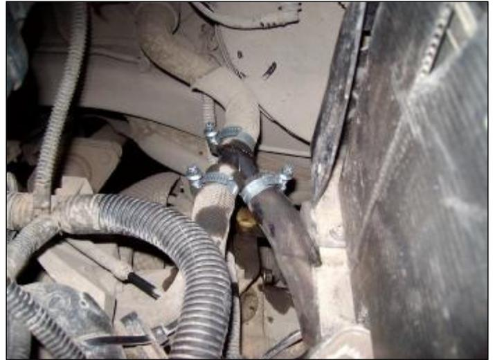
**Рис.2. Схема монтажа тройника  $\text{Ø}16\times 16$  и выходного рукава.**
