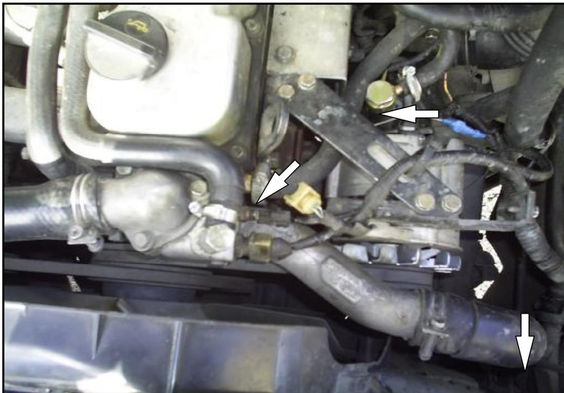
**Рис. 2 (1-й способ-подача нагретой ОЖ; 2-й способ-место монтажа тройника, фиксация (где это необходимо) рукавов**
