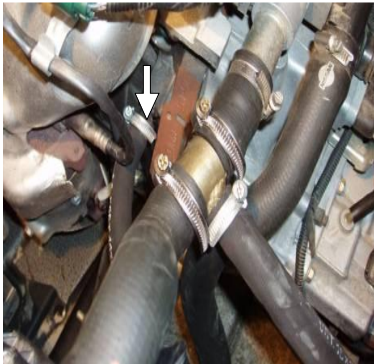
Рисунок 1 (входной и выходной рукав)
