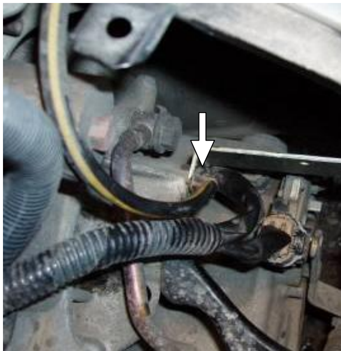
Рисунок 3 (крепление кронштейна на болт массы АКП)
