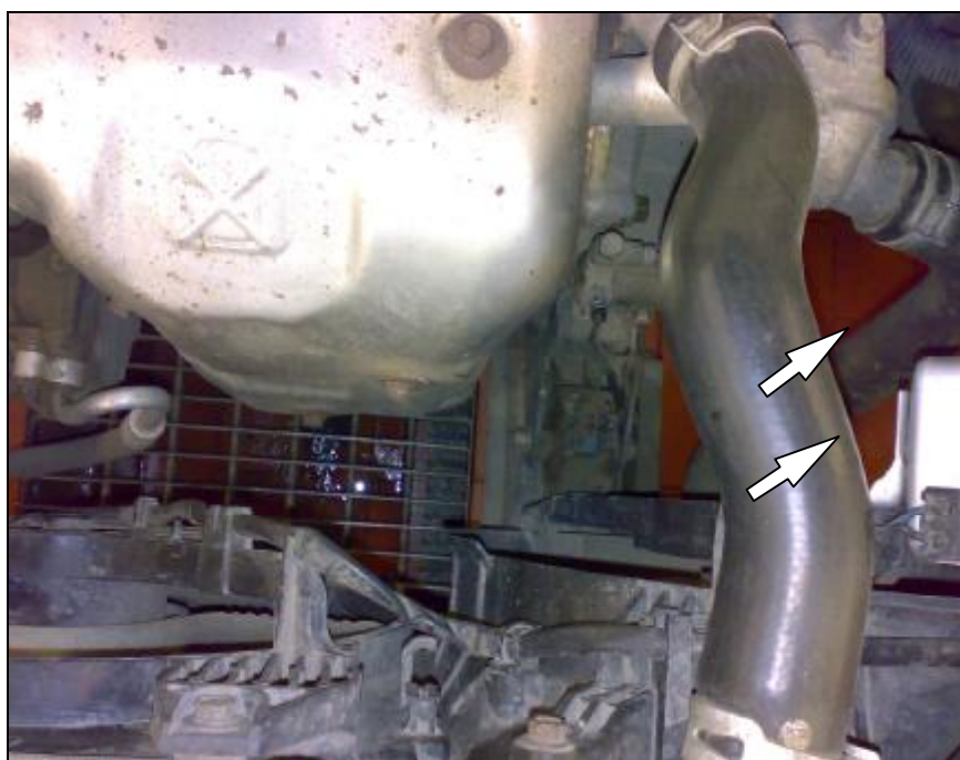
Рис.3 Крепление подогревателя (на примере МКПП)
