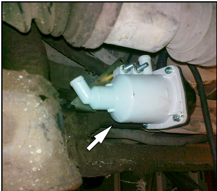
Рис.1 Монтаж подогревателя на кронштейне
