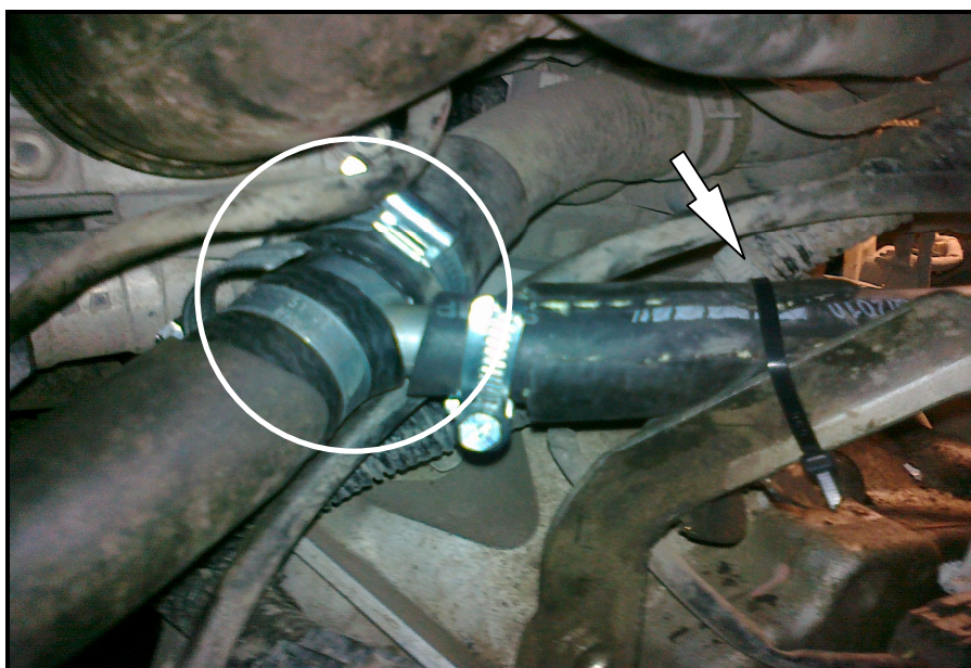
Рис.5 Положение тройника 28x16 и фиксация выходного рукава
