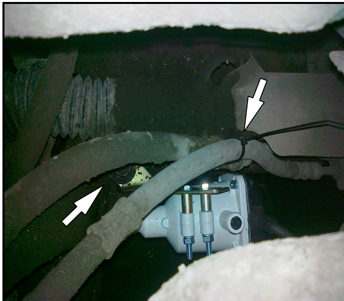
Рис.2 Болт крепления и фиксация шланга ЭГУР
