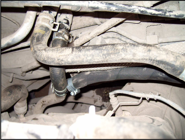
Рис.1. Монтаж тройника Ø16×16 и входного рукава.
