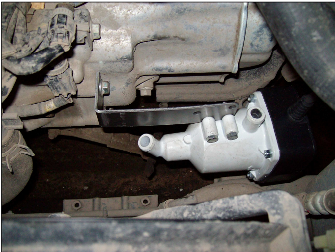
Рис.1. Схема монтажа кронштейна с электроподогревателем.
