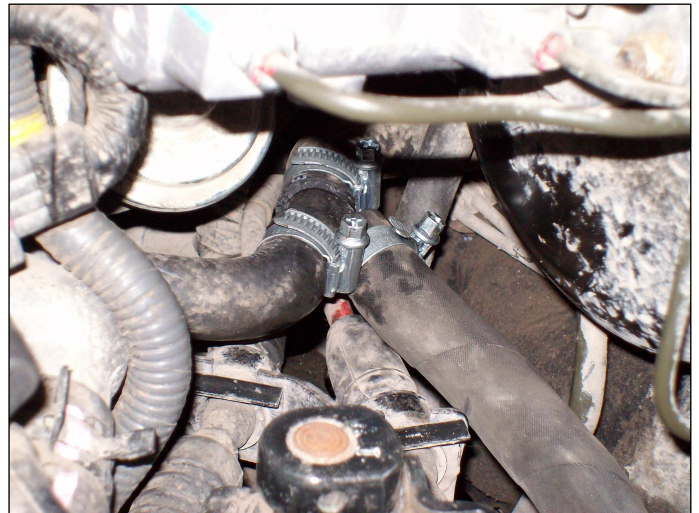
Рис.2. Схема монтажа тройника \text{Ø}16 \times 16 \times 16 и выходного рукава.
