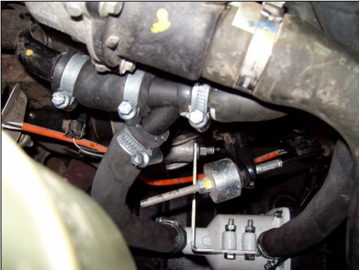
Рис.1. Монтаж кронштейна с электроподогревателем, тройника \text{Ø}19 \times 16 , входного и выходного рукава электроподогревателя ( \text{Ø} 16 \text{ мм} ), рукава ( \text{Ø} 18 \text{ мм} ).
