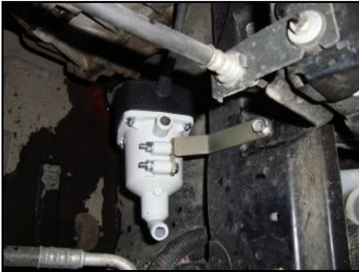
Рис.1. Монтаж кронштейна с электроподогревателем (вид с верху).
