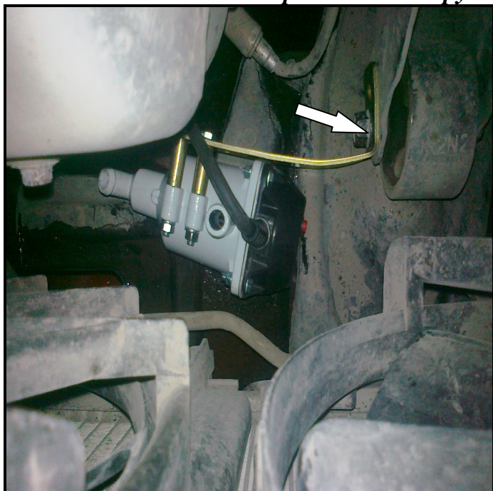
Рис.1 Способ монтажа подогревателя к опоре
