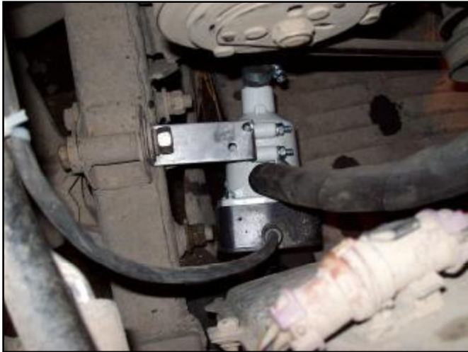
Рис.1. Схема монтажа кронштейна с электроподогревателем и выходного рукава.
