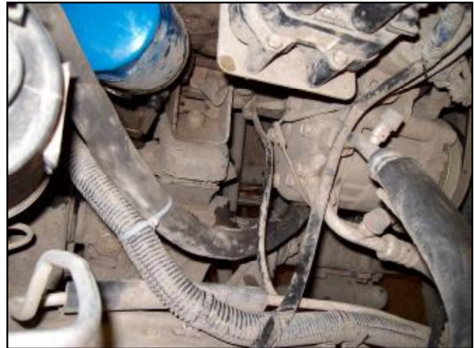
Рис.4. Схема фиксации входного рукава пластиковым хомутом.
