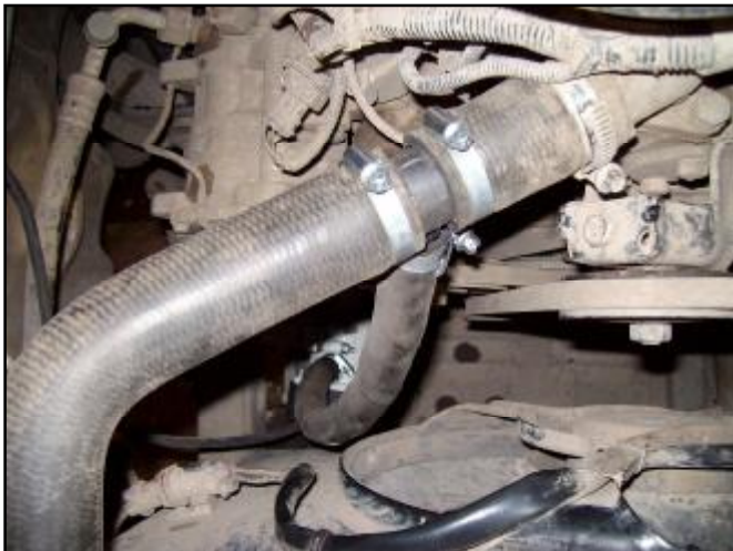
Рис.3. Схема монтажа тройника Ø33×33×16 и выходных рукавов.
