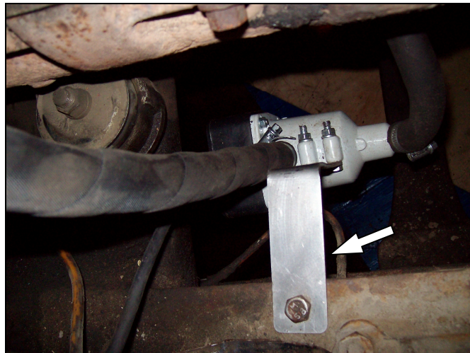
Рис.2. Схема монтажа кронштейна с электроподогревателем.
