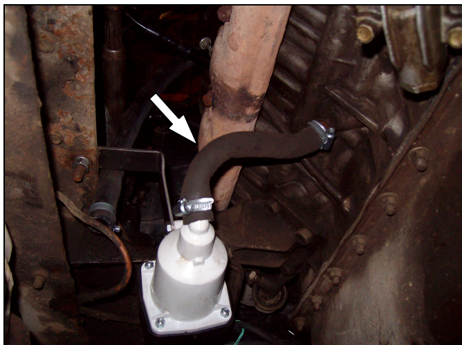
Рис. 1. Схема монтажа штуцера с входным рукавом.
