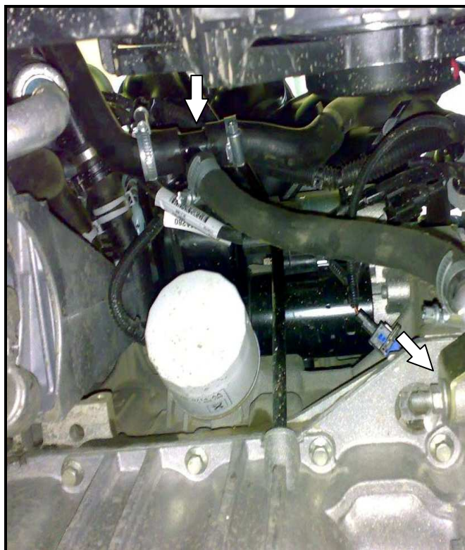
Рис.1 крепление подогревателя и монтаж тройника 19x16x19 (вид снизу)
