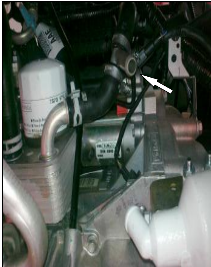
Рис.2 Положение тройника 19x16x19 и подогревателя
