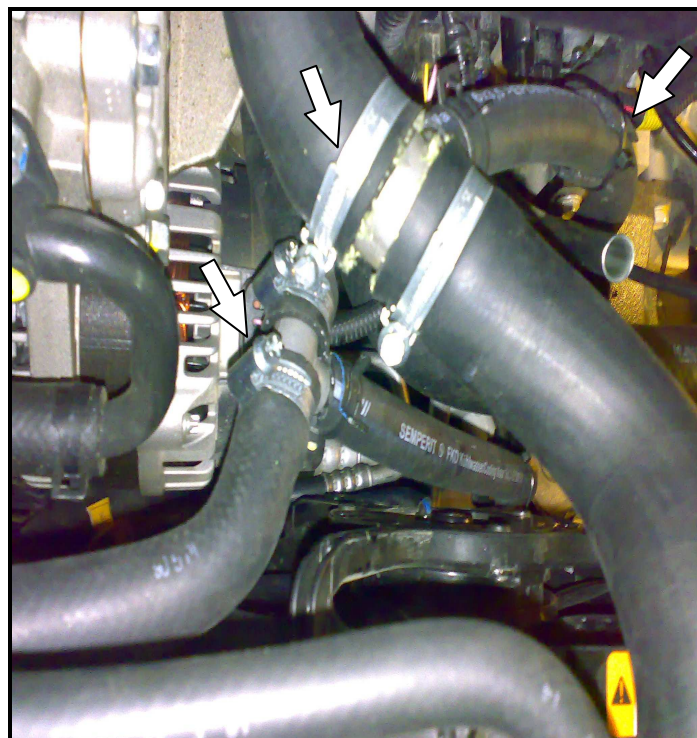
Рис.2. Положение входного и выходного рукавов, а также способ фиксации рукавов.
