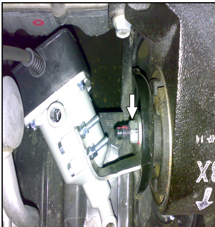
Рис.1. Положение подогревателя и болт крепления.
