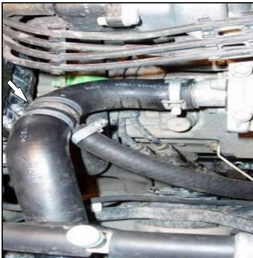
Рис. 3 монтаж тройника 33x33x16
