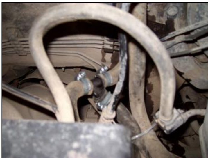
Рис.2. Схема монтажа тройника Ø16 и входного рукава.
