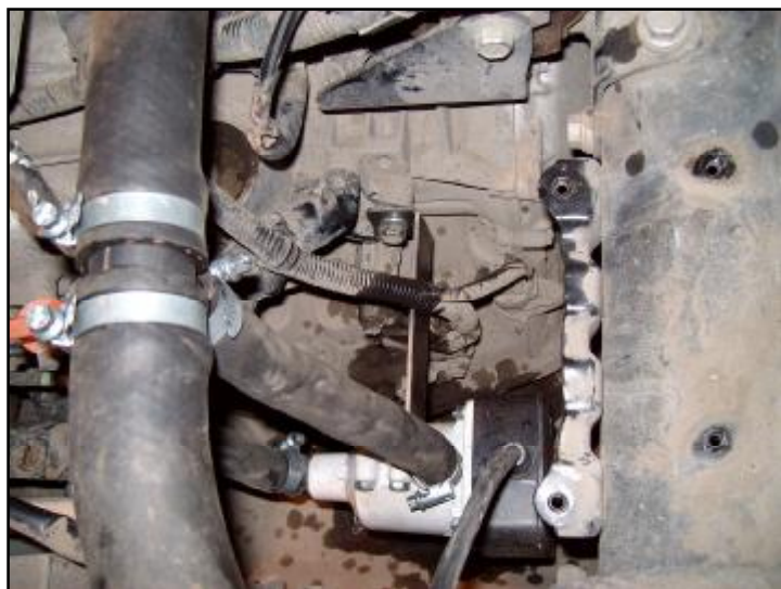
Рис.1. Схема монтажа кронштейна с электроподогревателем, тройника Ø33×16, входного и выходного рукава.
