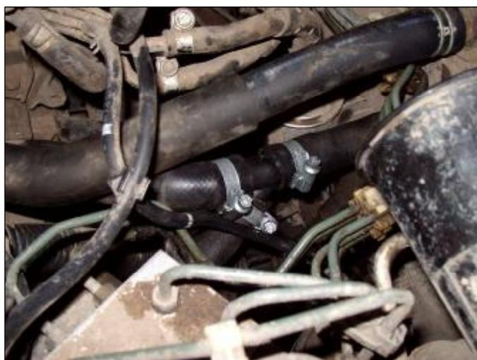
**Рис.4. Схема монтажа тройника Ø18×16**
