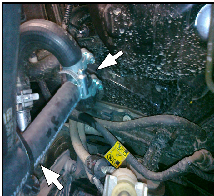
Рис.3а. Положение тройника 19x16x19 и фиксация входного рукава.
