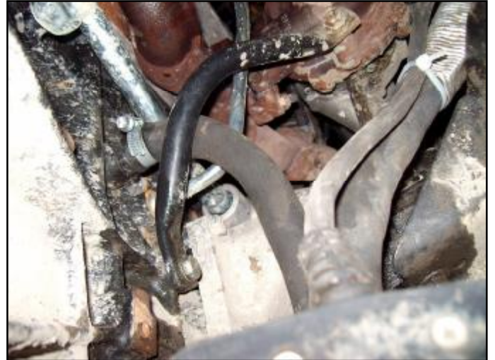
Рис.2. Монтаж штуцера M18x1,5 и входного рукава.
