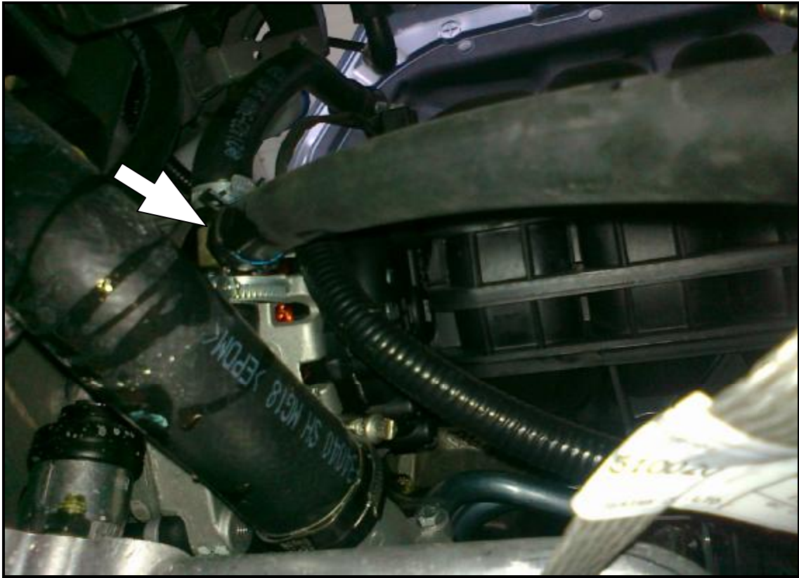
Рисунок 3. Положение тройника 14x16 (вид снизу).
