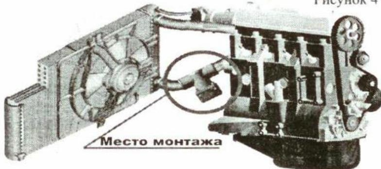
Электроподогреватель устанавливается в разрез нижнего патрубка радиатора (для автомобилей с верхним расположением термостата).
