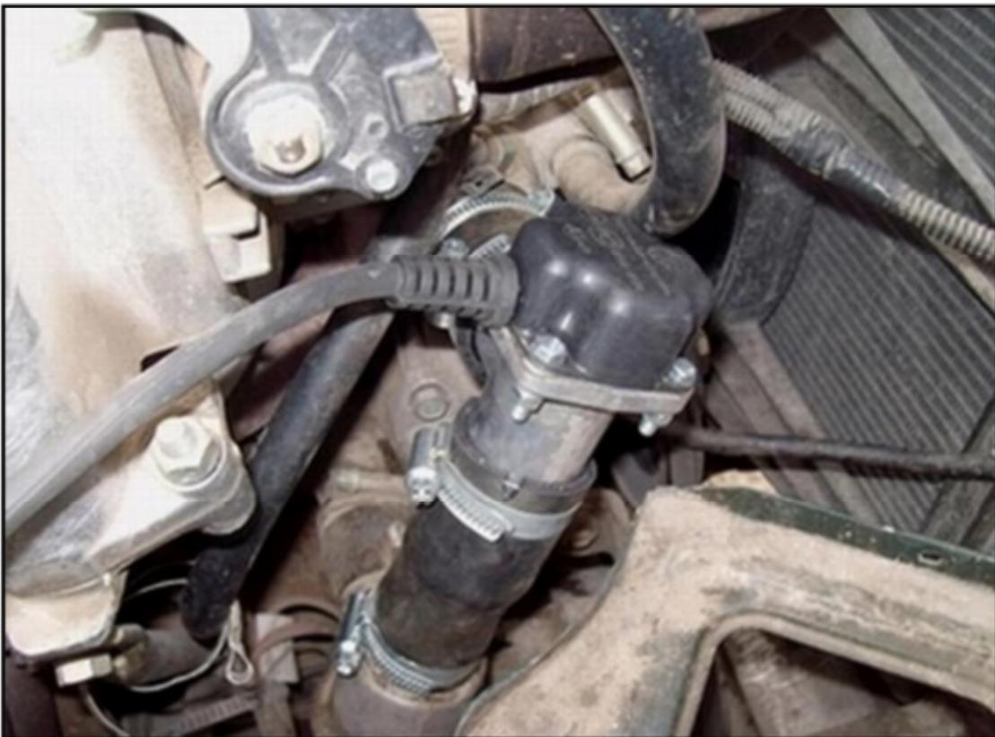
Рис.4 Монтаж подогревателя на моделях классической компоновки
