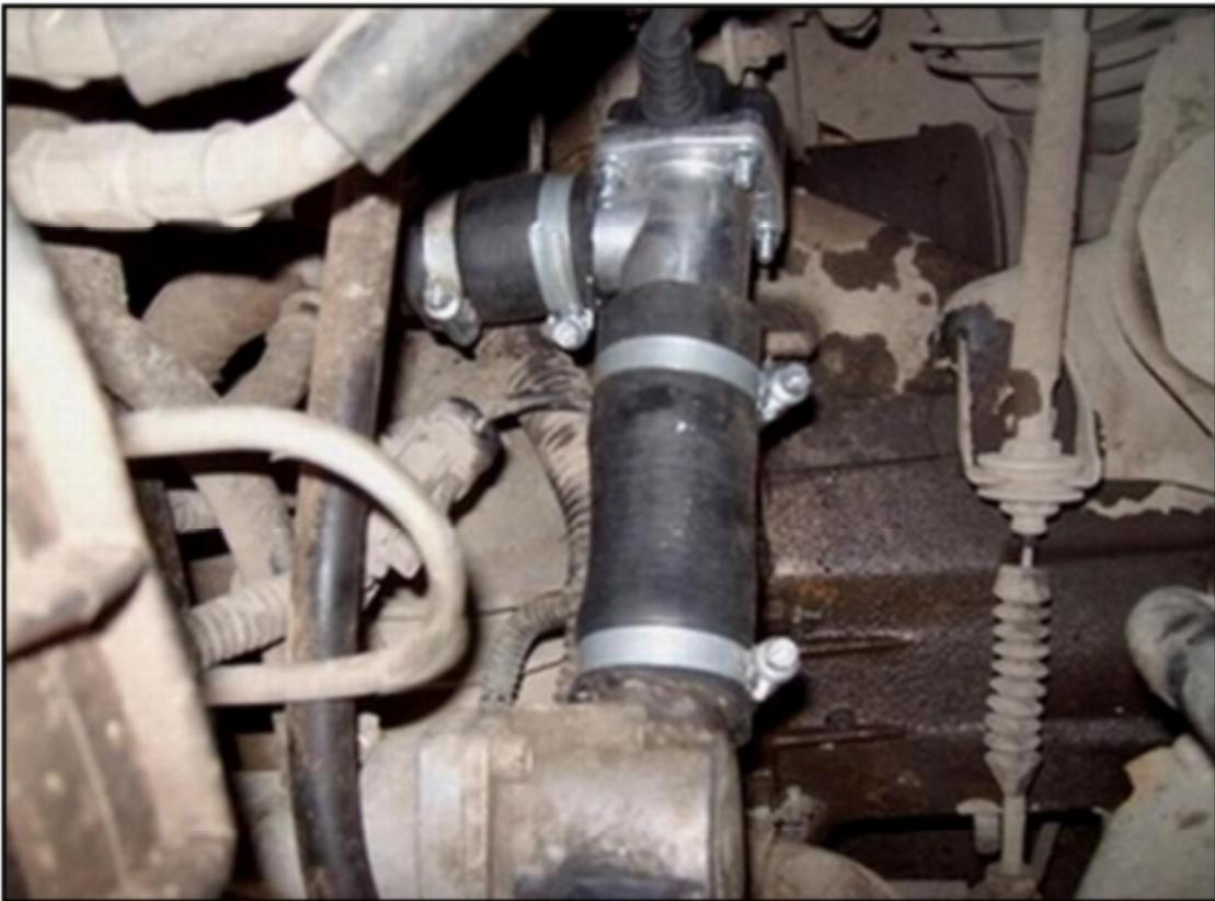
Рис. 3 Монтаж подогревателя на переднеприводных моделях
