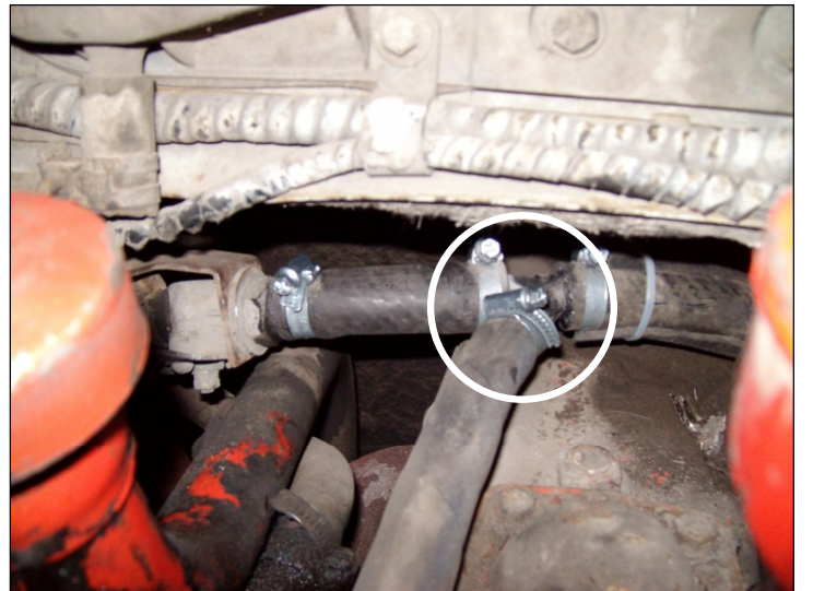
Рис.4. Схема монтажа тройника Ø19×19×16 и выходного рукава.
