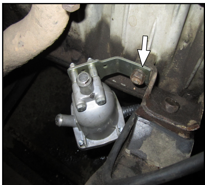
Рис.3 Монтаж подогревателя и гайка крепления
