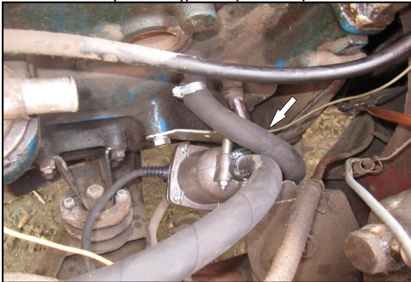
Рис. 1. Схема монтажа кронштейна с электроподогревателем и входного патрубка.
