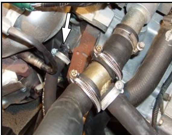
Рис.1. (на примере двигателя марки NISSAN QG16). Верхний патрубок радиатора перевернут, как описано в инструкции.
