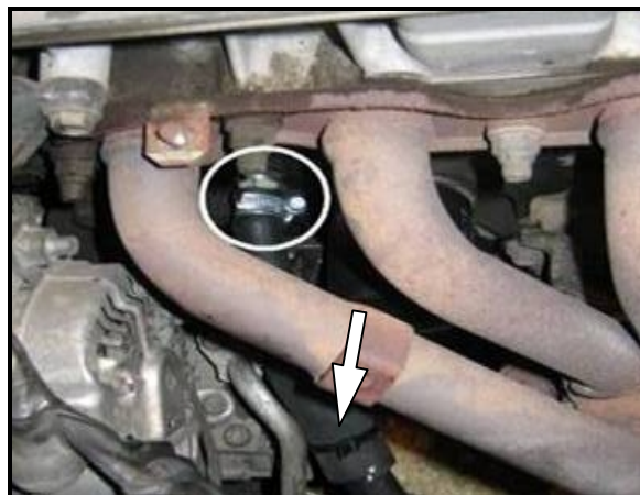
Рис.2. Сливная пробка двигателей TOYOTA и способ фиксации рукава.
