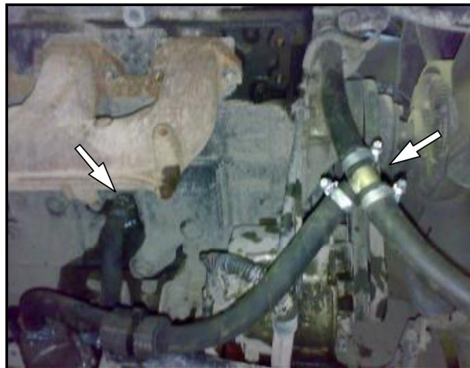
Рис. 2 Привязка подогревателя по принципу забор ОЖ со сливной пробки блока двигателя, подача нагретой ОЖ в печной патрубков
