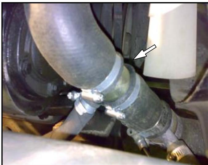
Рис. 3 Привязка подогревателя по принципу забор ОЖ с нижнего патрубка радиатора, подача нагретой ОЖ в сливную пробку блока двигателя)
