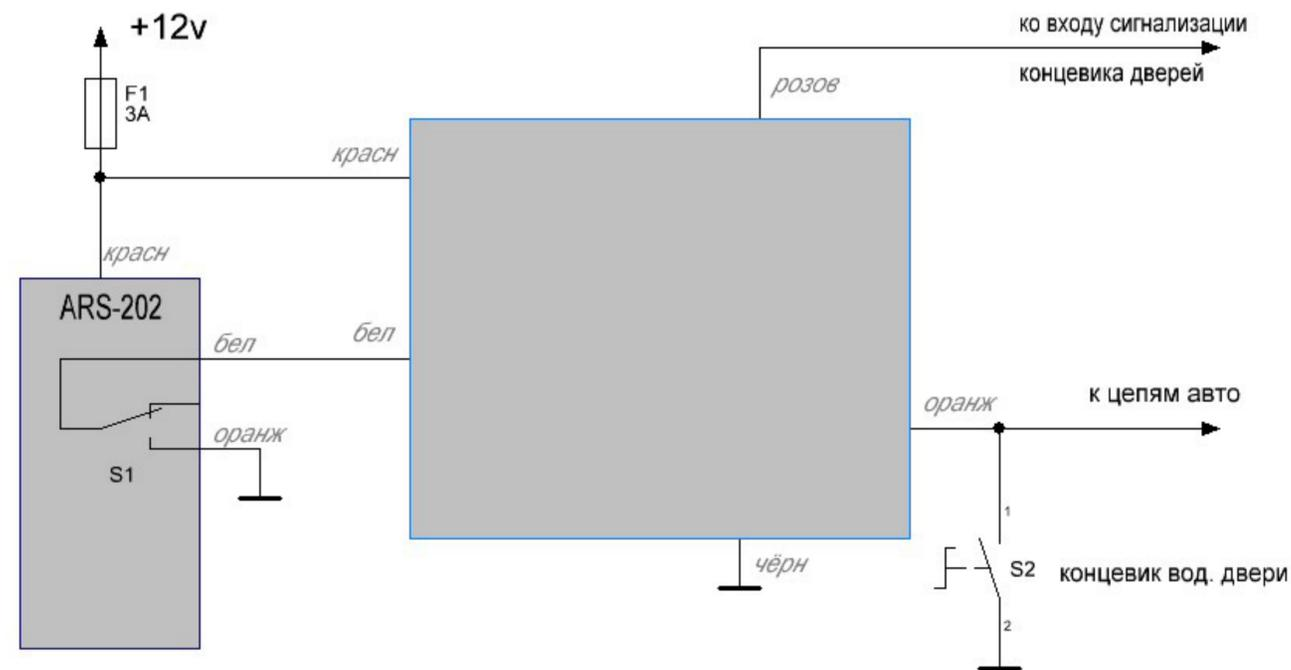
Отключатель света автомобиля, после окончания работы запуска
