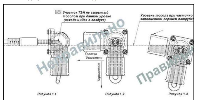
При установке подогревателя на ВАЗ 2101...2121 необходимо располагать его так, чтобы воздух не скапливался внутри корпуса, как показано на рис 1.1 и 1.2. На этом участке (без жидкости) ТЭН будет перегорать, и подогреватель выйдет из строя. Используя шланги из комплекта, расположите подогреватель как показано на рис 1.3. При заполнении системы тосолом, воздух выпускайте в месте, указанном стрелкой (например: при ослабленном хомуте вставить отвертку между шлангом и корпусом, при
