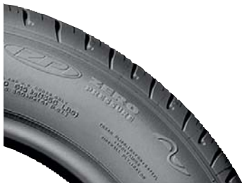
ZP (Zero Pressure): коммерческое название самонесущих шин MICHELIN
