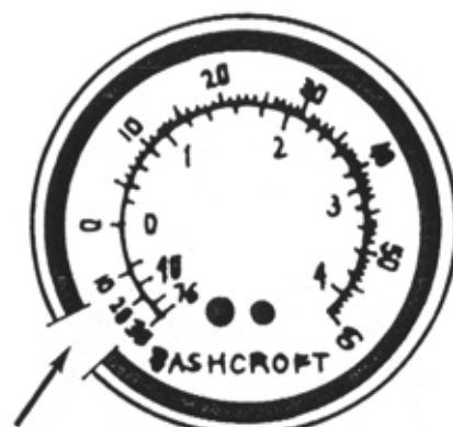
Типичный диапазон вакуума 15-25 дюймов ртутного столба
