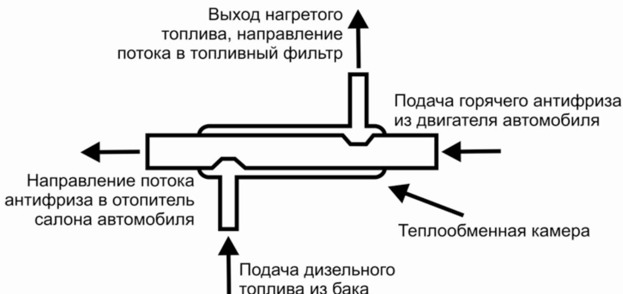
Корпус подогревателя изготовлен из высококачественной нержавеющей стали марки: 08X18H10 (Aisi-304). Все части корпуса подогревателя соединены герметичным сварным швом и не являются разборными. Подогреватель не нуждается в сервисном обслуживании. Сменные штуцера имеют резьбовое соединение с корпусом подогревателя: M10x1,5 мм. Штуцера могут быть изготовлены как из нержавеющей стали Aisi-304, так и из алюминия марки Д16Т.
