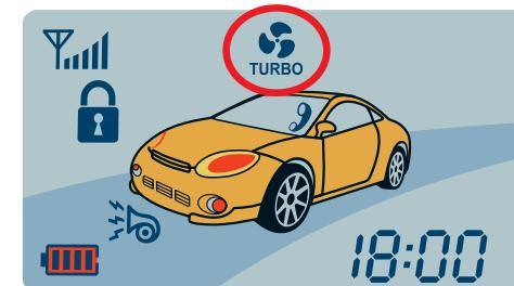
При помощи программируемой функции 1-16 (см. стр. 70), Вы можете выбрать способ включения режима «Турбо»:
