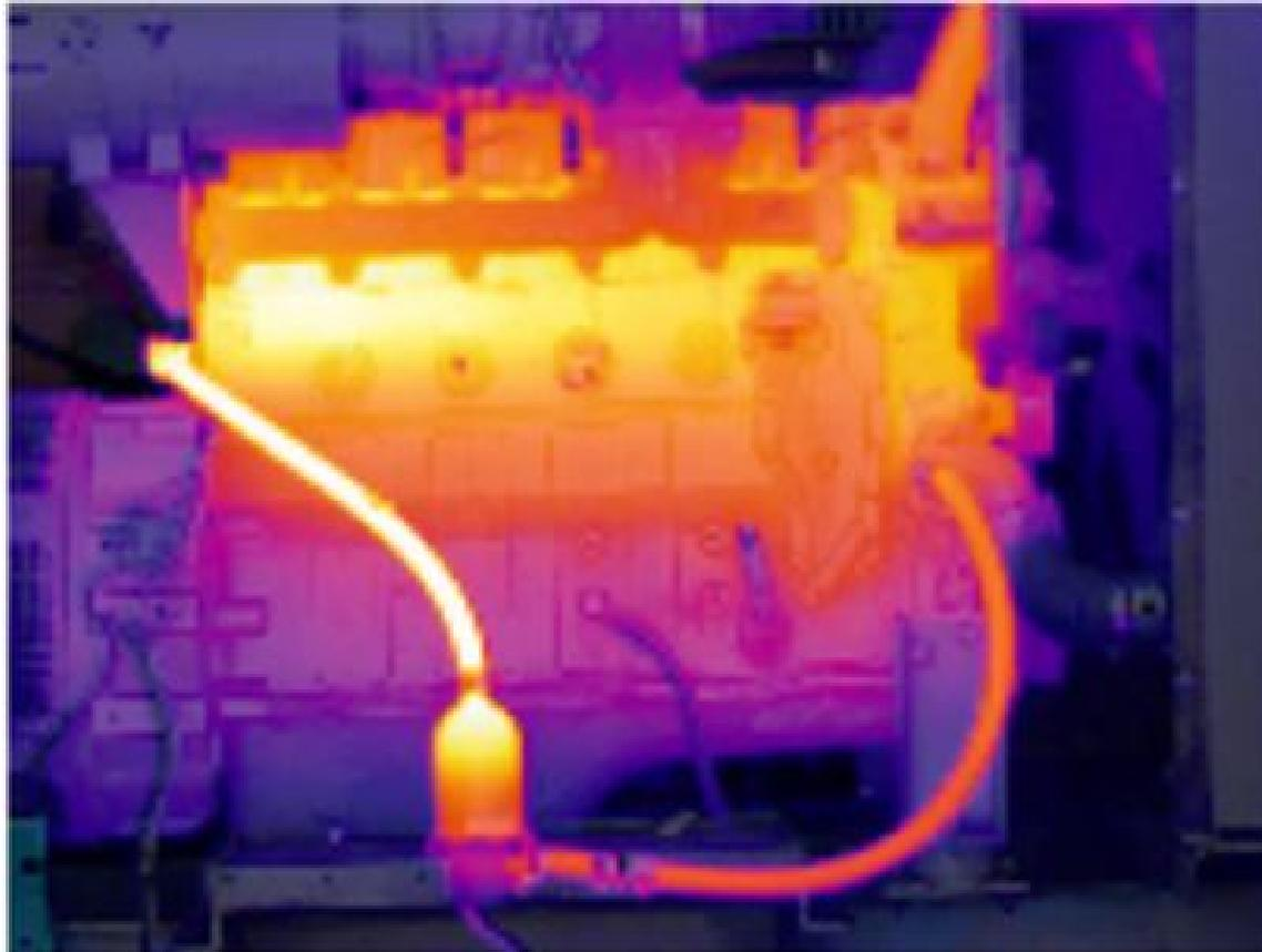
Прогрев двигателя подогревателем СТМ с принудительной циркуляцией
