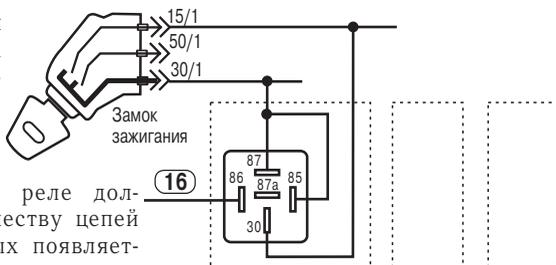
Количество внешних реле должно соответствовать количеству цепей замка зажигания, в которых появляется питание при включении зажигания.
