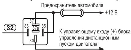
Если блок управления требует положительного управляющего импульса, проинвертируйте сигнал с помощью дополнительного реле:
