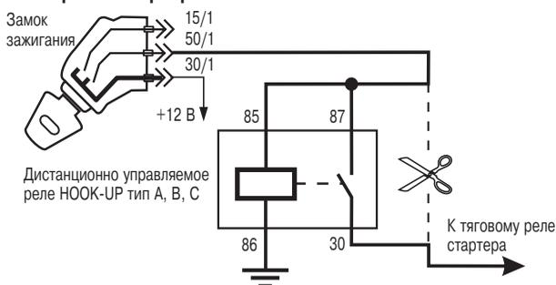
Блокировка стартера на приведенной схеме нарушает требование постоянного присутствия +12 В на вводе приема сигналов управления реле NOOK-UP®, но такое подключение предотвращает включение стартера при работающем двигателе.
