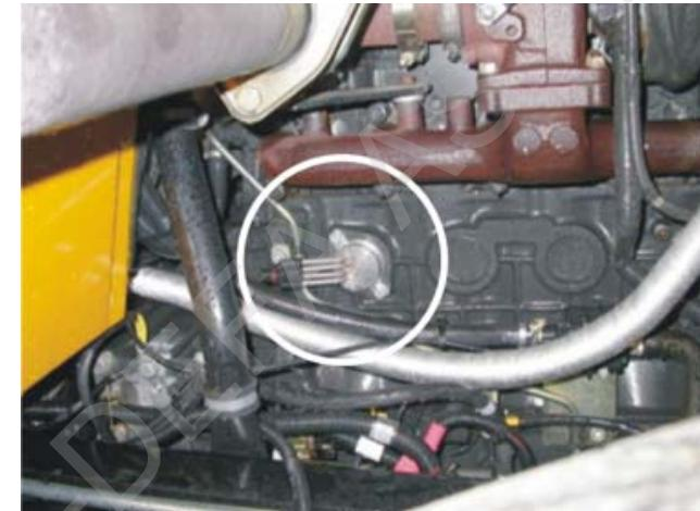
N Demonter frostlokket (1). Rengjør hullet grundig for lakk o.l. Monter varmeren. Benytt de medleverte bolter og festebrikker for festing av varmeren. Påse at brikkene ligger korrekt på varmerens flens. Påfyll godkjent kjølevæske, og luft systemet iflg. bilprodusentens spesifikasjoner. Kontroller for lekkasje.
