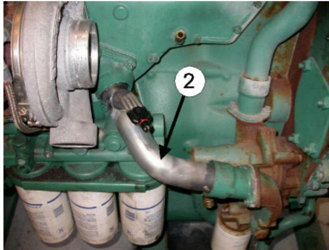
**N** Demonter det originale røret (1) og erstatt det med varmeren (2). Benytt de vedlagte nye pakningene. Kontroller for lekkasje. Påfyll godkjent kjølevæske, og luft systemet ifølge bilprodusentens spesifikasjoner.
