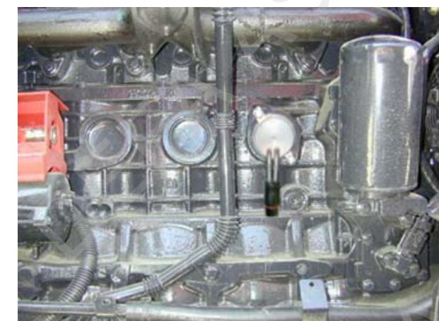
N Demonter fremste frostlokket (1). **NB!** Rengjør hullet grundig før lakk osv. Monter varmeren, varmeren festes med de medleverte brakettene og skruene med låseskiver. Påse at brakettene ligger korrekt på varmerens flens. Fyll på godkjent kjølevæske, og luft systemet iflg. motorprodusentens spesifikasjoner. Kontroller for lekkasje.
