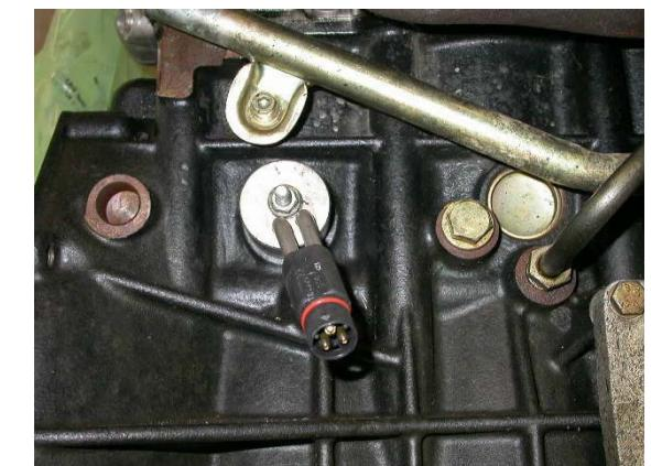
**N** Demonter frostlokket. **NB!** Før montering rengjøres hullet godt. Dyp varmeren i frostvæske for å smøre pakningene. Monter varmeren så langt inn i hullet som mulig, og trekk til muttern slik at varmeren trekkes mot blokken. Påse at o-ringen ikke skades. Fyll på godkjent kjølevæske og luft systemet godt, iht bilfabrikantens spesifikasjoner. Kontroller for lekkasje.
