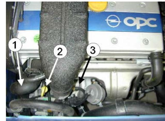
**N** Demonter øvre radiatorslange (1) og løsne peilepinnerøret (2). Løsne eventuelt dekselet over eksosmanifolen (3). Demonter frostlokket og monter varmeren. Monter tilbake demonterte deler. Fyll på godkjent kjølevæske, og luft systemet iflg. bilprodusentens spesifikasjoner. Kontroller for lekkasje.
